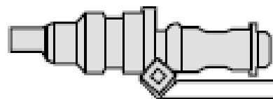
inyector de arranque en frío
